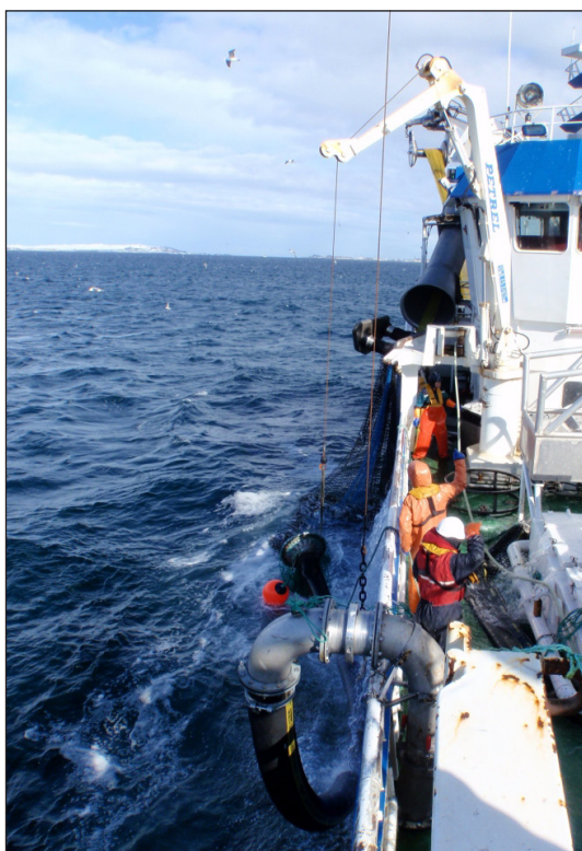
Bilde 27–28: Slangen fra under-/overtrykkspumpen blir festet direkte til snurrevadens cod-end og lagt langs fartøyets styrbord side. Skipperen tørker sekken på Triplex slik at fisken strømmer uten hindringer om bord.
