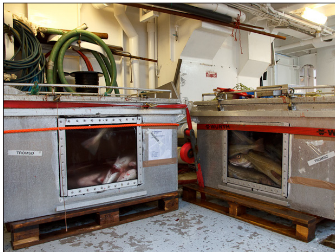
Bilde 8–9: Fra forsøk med levende fisk fra trål; mer enn 90 % overlever selv om fisken hales opp på tråldekket først.
