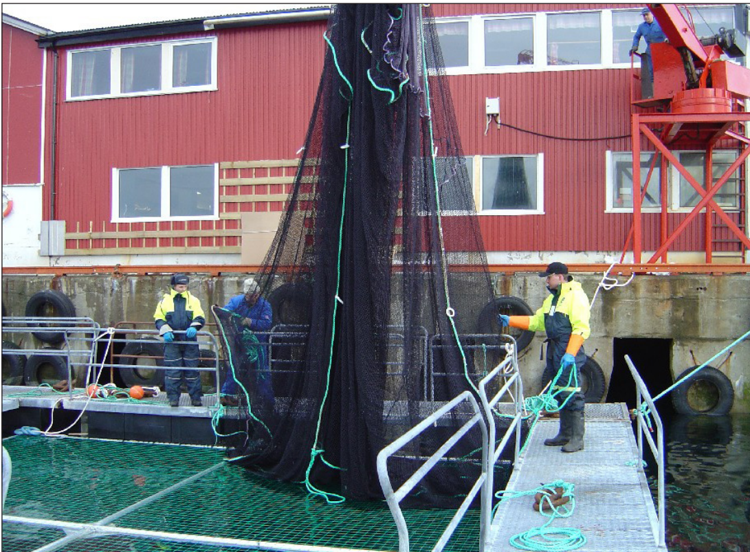
Bilde 56: Gamle stålanlegg fra lakse- og torskoppdrettsnæringen er populære for ombygging til mottaksmerder. En stabil ramme i aluminium danner grunnlaget for trampoline og bunnen av merden. Størrelsene varierer fra 5x5 meter til 20x20 meter.
