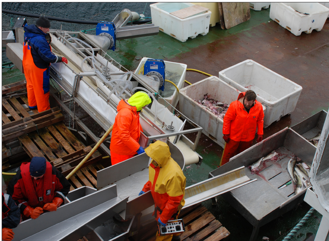
Bilde 46: Sorteringsanlegg ved MARE AS, i Havøysund. Fangsten pumpes på land, død og døende fisk sorteres ut.
