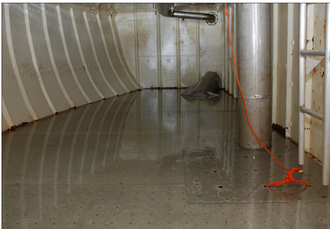
Bilde 39: Utforming av dobbelbunn om bord på M/S «KILDIN». Legg merke til lav perforering, hull for hver 10x10cm, og med 8 mm hull. Luke over pumpebrønn kan løftes vekk når lossing skal starte.
